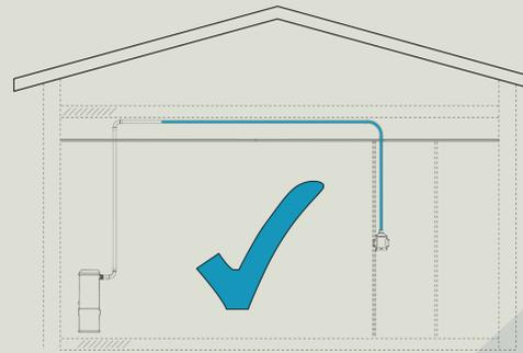
Réseau de rangement du flexible avec développement horizontal par le haut et descente en vertical uniquement pour le raccordement à la prise.
