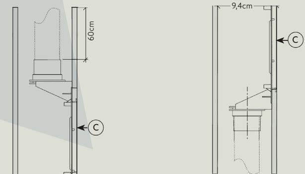
L'encombrement minimum de la contre-prise est de 9,4cm en profondeur.
