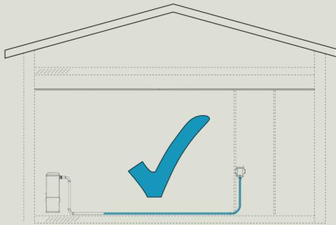
Réseau de rangement du flexible avec développement horizontal par le bas et monté en vertical uniquement pour le raccordement à la prise.
