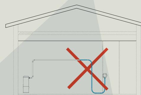
Ne pas installer le réseau de rangement du flexible en double colonne à la verticale, ne pas installer 2 coudes à la suite l'un de l'autre, prévoir au moins 1m entre eux.
