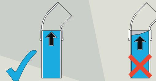
La coupe des conduits doit être parfaitement droite et sans aucune bavure.
