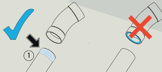
La colle s'applique sur le tube uniquement (1), s'assurer que le conduit arrive bien en butée au fond des raccords.
