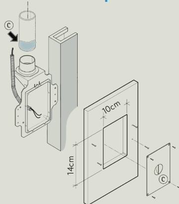
Aligner les bords extérieurs de la contre-prise au mur brut ou à la structure avant l'enduit de finition, panneau de bois ou la plaque de plâtre.
