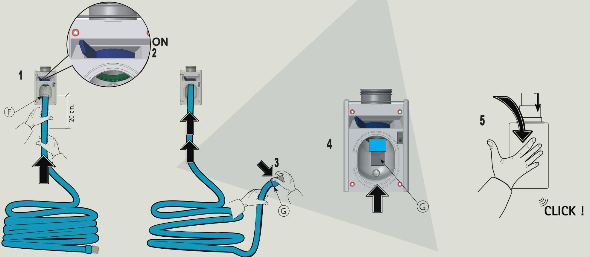
1. Ouvrir la porte, veiller à ce que le levier de blocage soit en position déverrouillé et insérer dans la prise l'extrémité bagué du flexible (F) sur une longueur d'environ 20cm.
